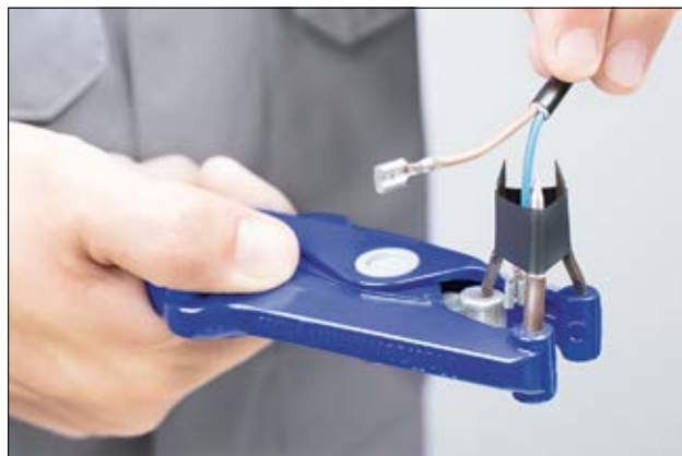
Applicazione veloce e precisa con le pinze a tre becchi per l'espansione.
