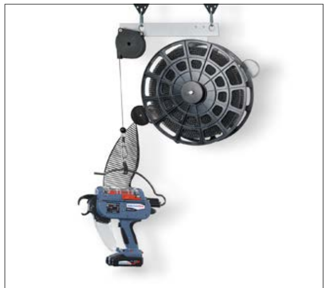
Supporto sospeso CPK con Autotool CPK hybrid alimentata a batteria (presenti anche fascette T18RA3500).
