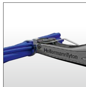
4. Inserite il corpo fascetta nel lato aperto della parte anteriore dell'utensile e spingete avanti fino a toccare la testa della fascetta.
