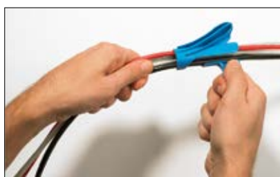
Inserire uno o più cavi nell'apposito foro dell'utensile applicatore.
