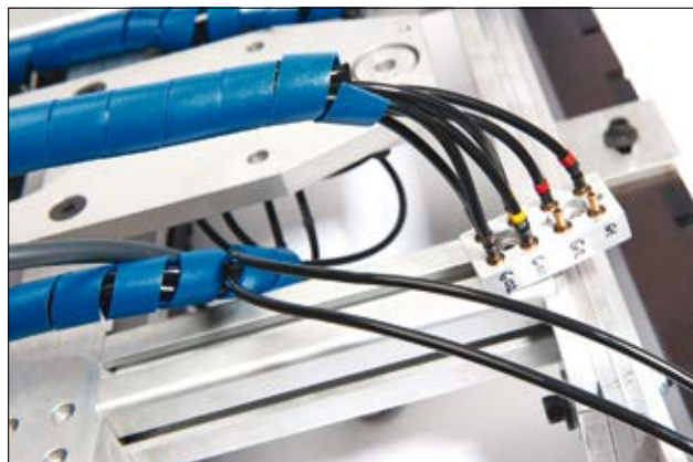
La spirale a contenuto metallico protegge i cavi delle macchine per l'industria alimentare.
