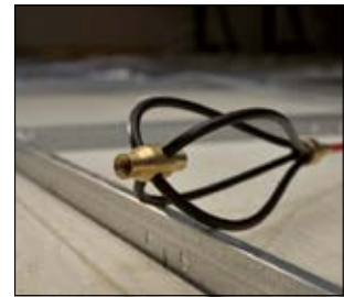
Whisk consente all'astina di scivolare facilmente sopra agli ostacoli.
