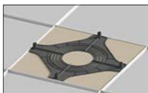
1. Posizionare lo SpotClip-Plate in posizione.
