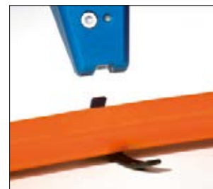
...rilascia il bottone attuatore e rimuovi l'attrezzo, la fascetta è tagliata.
