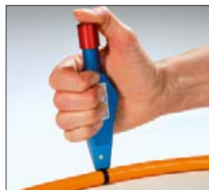
...premi sul bottone attuatore mantenendo la pressione sull'attrezzo
