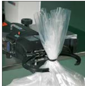
Chiusura sacchetti di plastica con kit da banco in posizione orizzontale.
