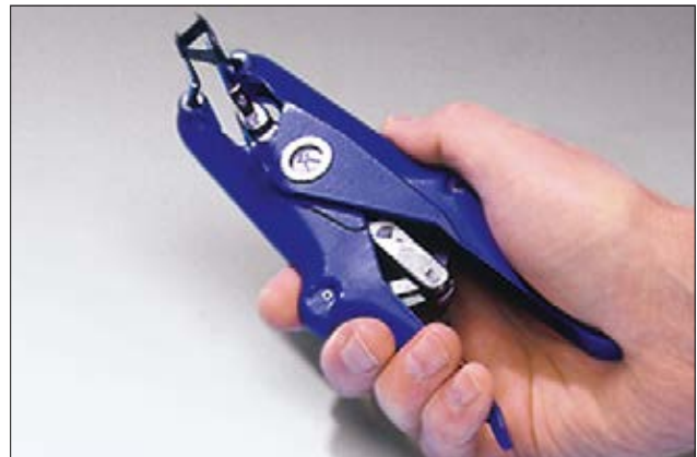
Applicazione veloce e sicura grazie ai tre becchi ad espansione.
