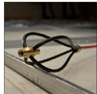
Il whisk consente all'astina di scivolare facilmente sopra agli ostacoli.
