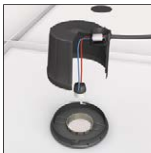
2. Collegare l'alimentatore all'attacco del faretto tramite i connettori HelaCon Lux forniti nella confezione e chiudere il distanziale con il sistema a baionetta.
