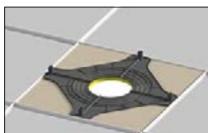
2. Tagliare il pannello del controsoffitto.
