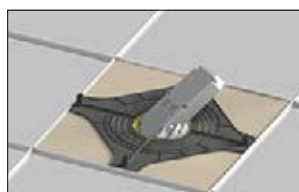
3. Inserire il faretto attraverso il foro.
