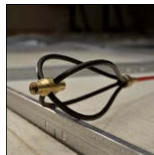
Il whisk consente all'astina di scivolare facilmente sopra agli ostacoli.
