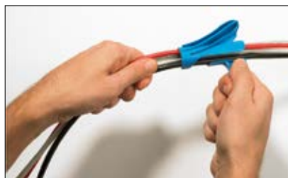
Inserire uno o più cavi nell'apposito foro dell'utensile applicatore.
