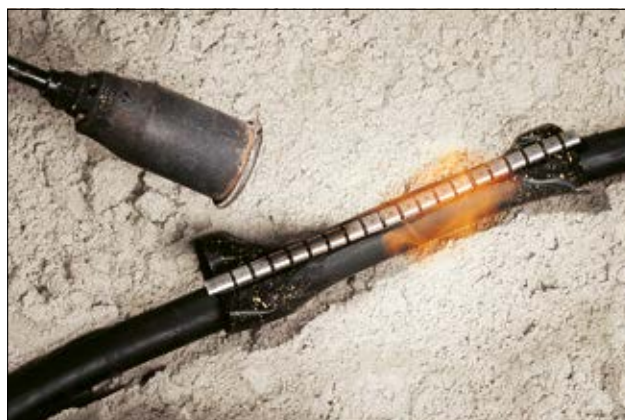
Manicotto avvolgente RMS per una riparazione veloce ed affidabile del cavo.
