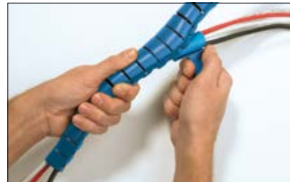
Inserire i cavi all'interno facendo scorrere l'utensile applicatore lungo la guaina Helawrap, come fosse una zip.
