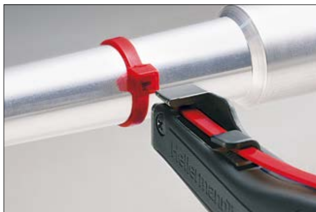
3. Taglio (Cut): L'operatore deve solo azionare la leva di tensionamento fino a tagliare la fascetta, senza contraccolpi né vibrazioni.
