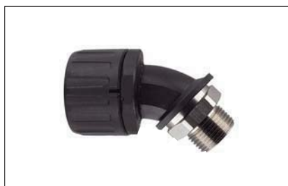
HelaGuard HG-45M Raccordo girevole curvato a 45° con filetto maschio, IP66.
