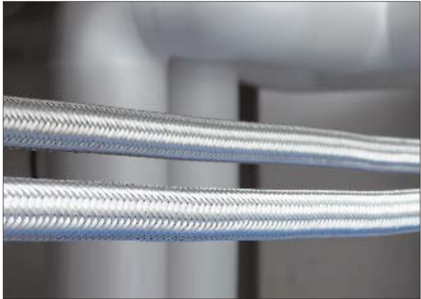
La guaina HelaGuard PCSB in acciaio zincato con rivestimento in PVC e calza in acciaio zincato offre un'elevata resistenza all'abrasione ed una schermatura EMC.
