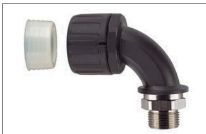
HelaGuard HGL-90M Raccordo girevole curvato a 90° con filetto maschio e guarnizione, IP68.
