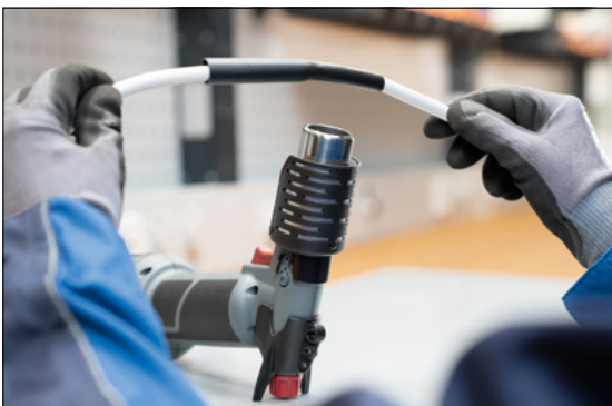
Applicazione del tubo termoretraibile a mani libere.
