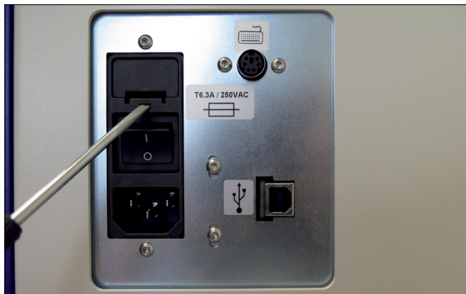
Sostituire il fusibile in ingresso alimentazione.
