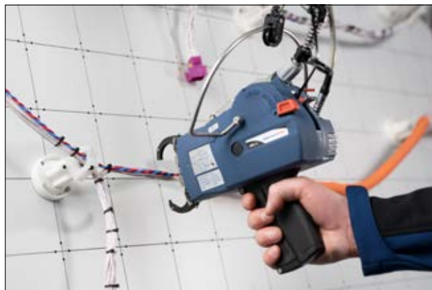
Autotool ATS flex sulla scheda di cablaggio (in figura anche: Sospensione sopraelevata ATS).
