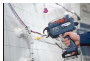
Autotool CPK hybrid alimentato a batteria in utilizzo con fascette in bandoliera.
