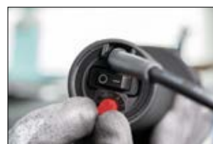
Impostando la temperatura di H6100.
