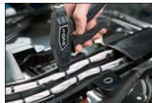
La fascetta può essere tagliata in qualsiasi parte della coda.
