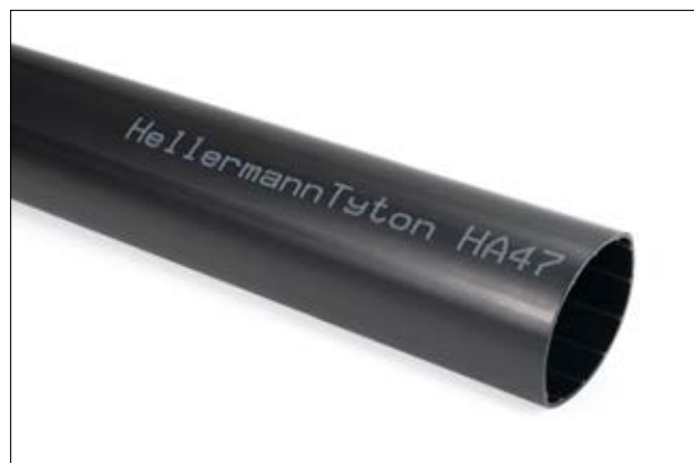
HA47 - guaina termorestringente a parete spessa con adesivo 4:1 zero alogeni.
