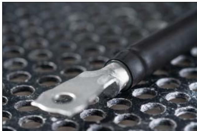
TA37 - Guaina termorestringente a parete sottile con adesivo 3:1 zero alogeni e autoestinguente.
