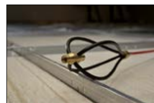
Whisk consente all'astina di scivolare facilmente sopra agli ostacoli.
