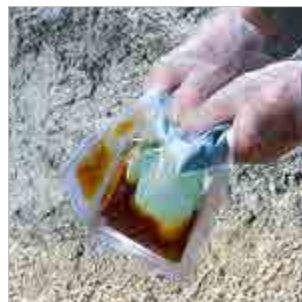
La termosaldatura che divide resina e indurente si apre applicando sufficiente pressione.
