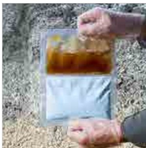
Sacchetto trasparente a doppia camera che permette di verificare il processo di miscelazione dei due componenti.
